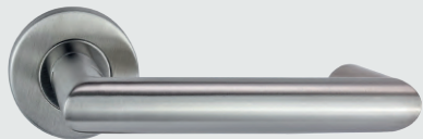
New York U Edelstahl matt 55 mm Ø Rosette / 8 mm Höhe inkl. EN 1906:2012 / DIN 18273 Feuerschutz inkl. EN179 Antipanik für Flucht und Rettungswege*
