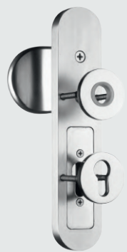
Goli X-Z Alu silber, EV 1 Sicherheitskombigrt. zur Gegenverschraubung von Rosettengarnituren; Außenschild mit Zylinderabdeckung für 15 mm Überstand
